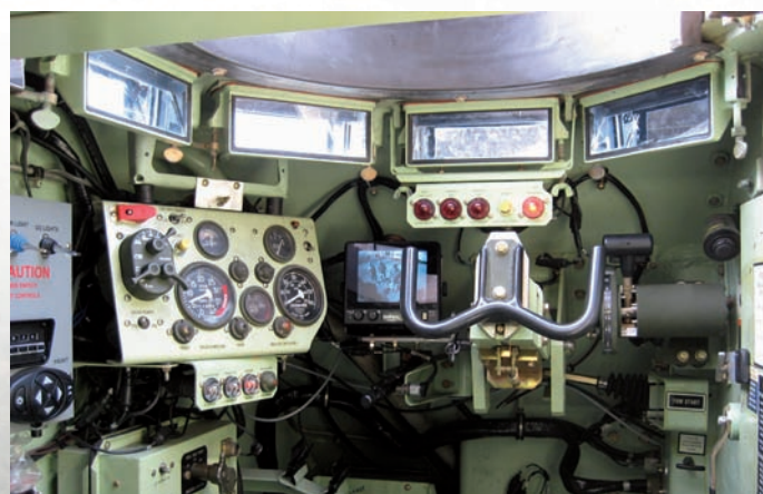
Depuis l'intérieur d'un blindé, les angles d'observation sont très restreints, ce qui pose problème notamment à courte portée.
